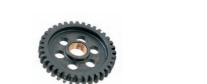
◀ cod. AM00010 Ingranaggio 1a velocità su secondario Z=36 per AM6 1° serie
